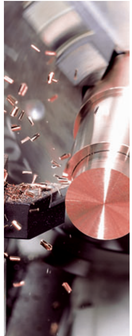
Formation de copeaux fins et uniformes lors des opérations de décolletage
